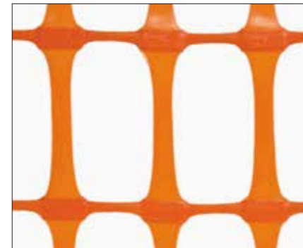
呼称 ネットガード 網目の大きさ(ピッチ) : 58mm x 90mm サイズ(幅 x 長さ) : 100cmx50m, 120cmx50m, 150cmx50m 色 : オレンジ/緑 | 主材料 : 高密度ポリエチレン ※写真は実寸より1/3縮小サイズです。 ※ネットガードの網目の大きさは、糸の中心から中心の間隔です。
