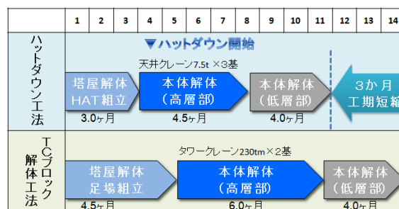
図 11 工事工程比較
