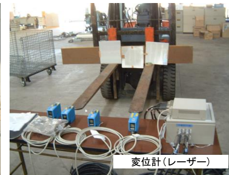
変位計モニター
