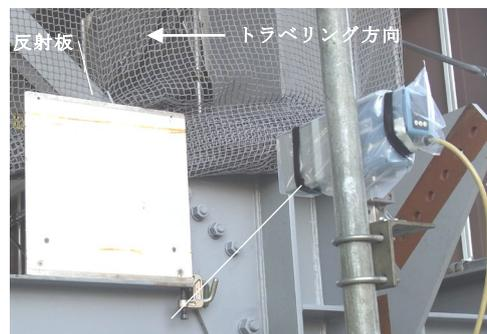
写真-7 レーザー距離計設置状況
