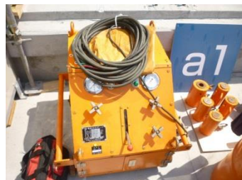
【油圧ポンプ・15kw】
